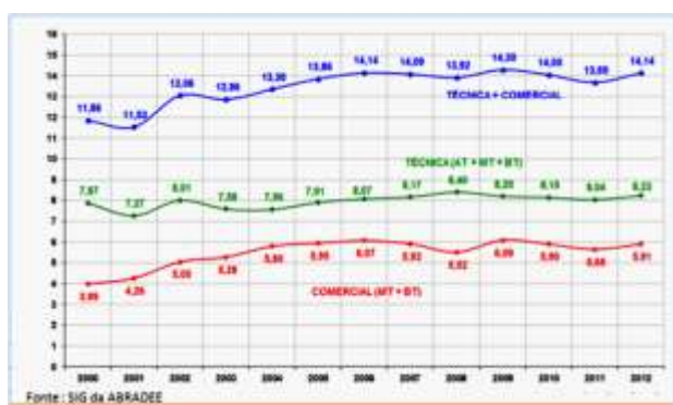
Figura 1 – Percentual de Perdas Técnicas (em verde) em relação à energia injetada no Sistema Global das 64 distribuidoras (Fonte: Abradee http://www.abradee.com.br/imprensa/artigos-e-releases/1018-perdas-na-distribuicao-baixa-tensao-altos-prejuizos-reportagem-especial-canal-energia )
