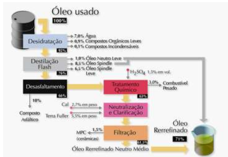
Figura 1. Processo de rerrefino (Fonte: http://www.sindirrefino.org.br/rerrefino/tecnologias )
