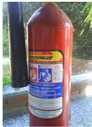
Figura 1: extintor de CO_2
